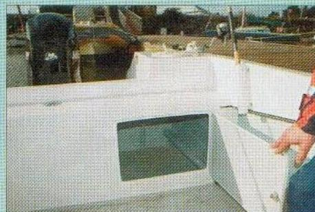
Les porte-cannes sont proposés comme option. Deux petits portillons à l'arrière s'ouvrent sur un vaste coffre technique accueillant le réservoir à carburant.
